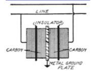
Fig. 205. Carbon Block Arrester
