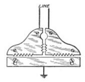
Fig. 204. Saw-Tooth Arrester
