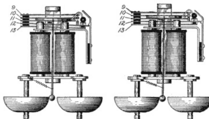
**Fig. 199. Broken-Back Ringer**
