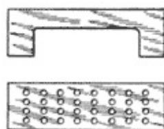
**Fig. 206. Arrester Separators**
