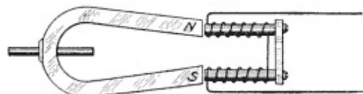
**Fig. 17. Elemental Magneto-Generator**
