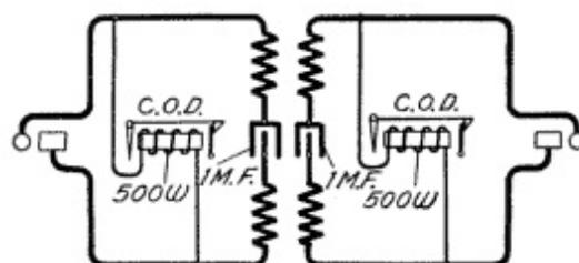
**Fig. 288. Double Clearing-Out Drops**
