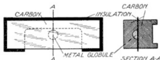
**Fig. 215. Carbon Air-Gap Arrester**[View full size illustration.](#)
