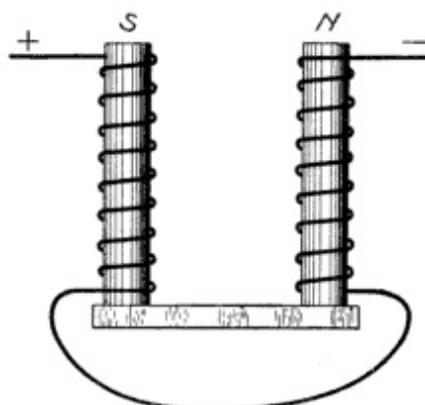
**Fig. 20. Electromagnet**
