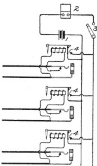
**Fig. 274. Night-Alarm Circuit**
