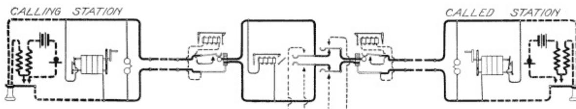
**Fig. 245. Clearing-Out Signal**
