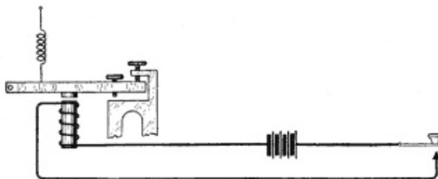
**Fig. 15. Telegraph Sounder and Key**
